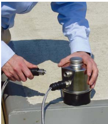
快速插拔的传感器连接电缆对POWERCELL PDX数字式网络可靠密封起着重要作用。
